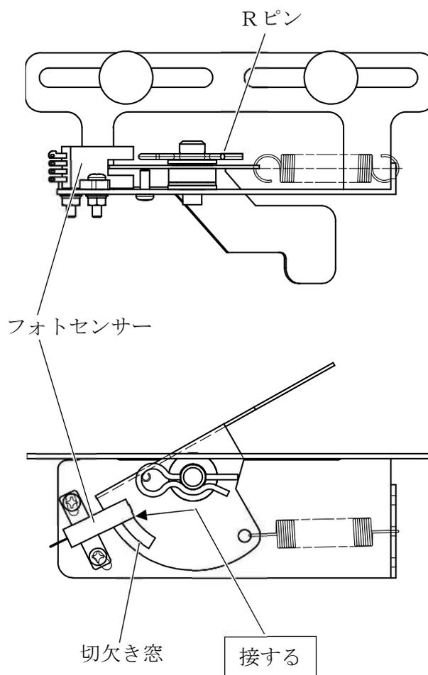
(注意) 上から見たとき、フォトセンサーと切欠き窓が接するようにフォトセンサーを組付けてください。
