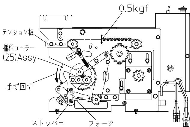
(9) (4) で緩めたハケ完結を元にもどし、ハケ先端を播種ローラーに接触させてください。
