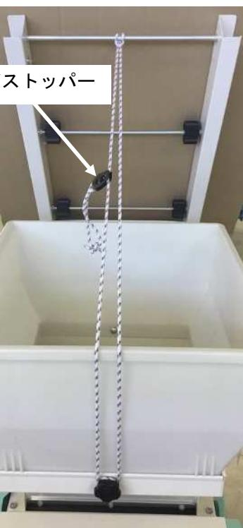
反対側のロープを、覆土ホッパーの補助ホッパーを固定しているノブナットに、引っかけます。この時、一巻きした方がより外れにくくなります。
