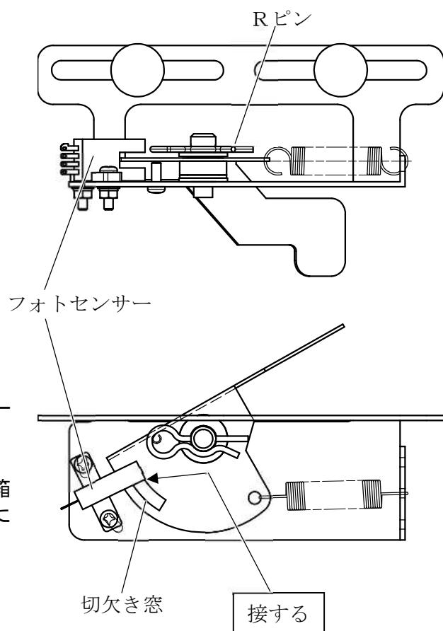
(注意) 上から見たとき、フォトセンサーと切欠き窓が接するようにフォトセンサーを組付けてください。
