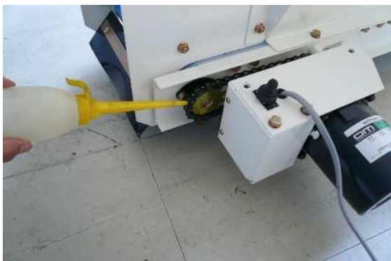
駆動チェーン及びローラーの軸受部 (カバーを外して注油してください)
