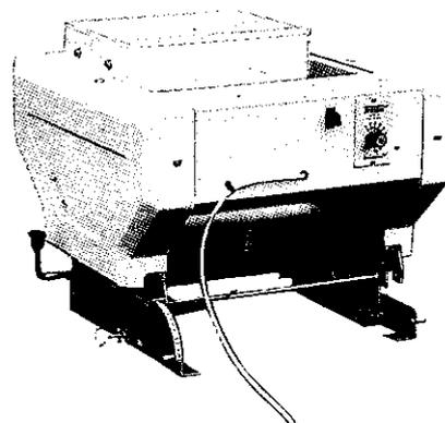
(ロ) 写真㉓の様セット後、矢印の方向に播種部を押して写真㉔の様セットして下さい。
