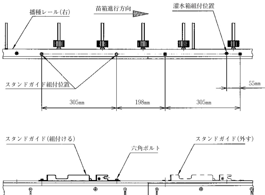
(ロ) スタンドガイド、灌水箱を組換えましたら、スタンドガイド下部に籾受け用吊り金具を組付けてください。(籾落とし回転ブラシは、播種ホッパーの後にセットします。)
