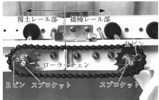
(ハ) 危険防止の為、必ず写真の様に、チェーンカバーをチョウボルトにて組付けてください。
