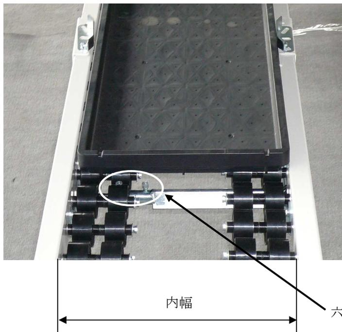
左図のようにレール内幅を決めます。連結金具中央部にある六角穴付ボルト 2本を緩めるとレールを広げられますので、任意の位置で六角穴付ボルトを締めてください。
