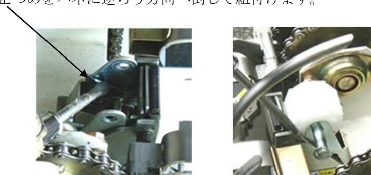
④ はさみカム軸を E 型止め輪で固定します。
