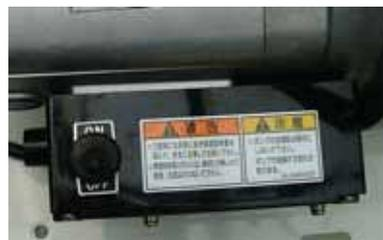
灌水装置のコックを開け、操作盤の前灌水・後灌水のスイッチを『入』にするとノズルから水がでます。
