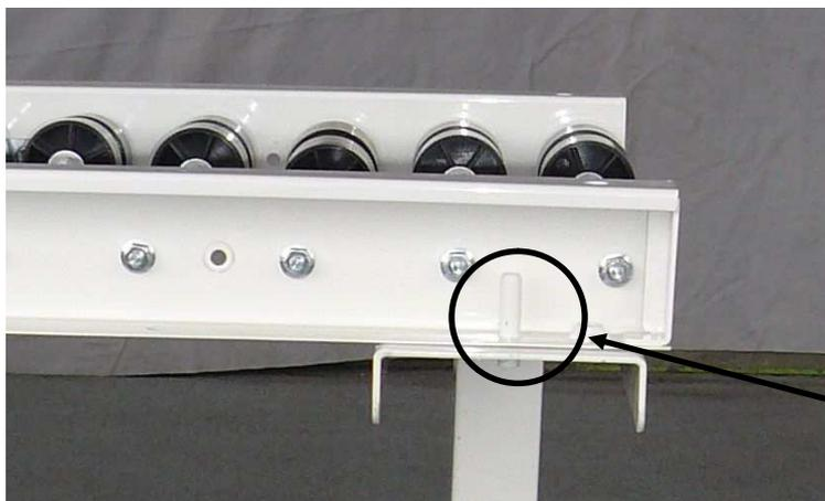
コロコンベアもしくは、ジョイントのφ9 穴にピンを差し込んでください。コロコンベアのピンをさした方の反対側のレールを、スタンドの上に乗せます。
