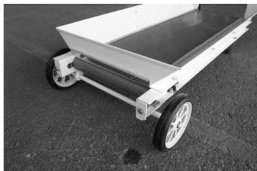
(2) 増枠を十字穴付トラス小ネジと座金付ナットで回収ホッパーへ組付けてください。
