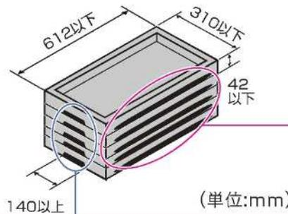
●手で持つための切欠きが無いものは使用不可。また切欠きの断面が下図のような形状のものは使用不可。
