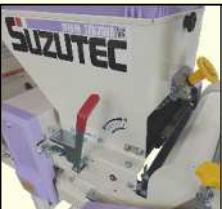
上位機種に搭載していたシャッター瞬時開閉機構に加え、シャッター開度がひと目で分かるゲージを追加しました。
